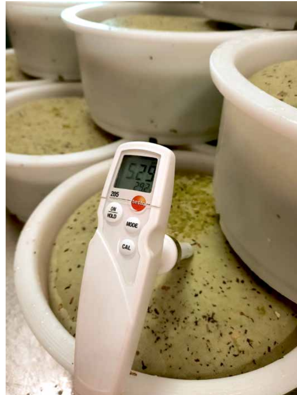
Hier wordt de verzuring van kaas gemeten.
